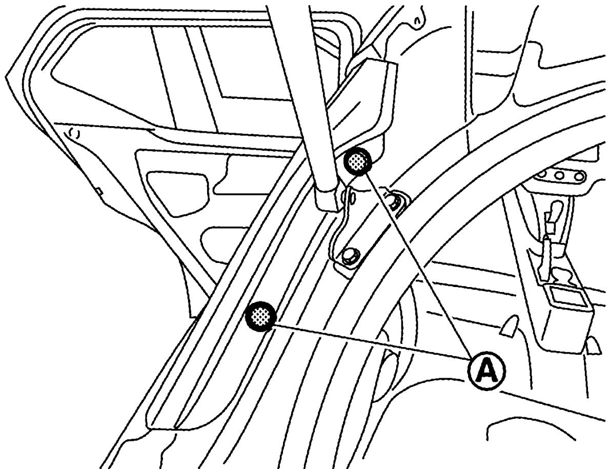
用保护胶带(A)保护零件以免受到损坏。
