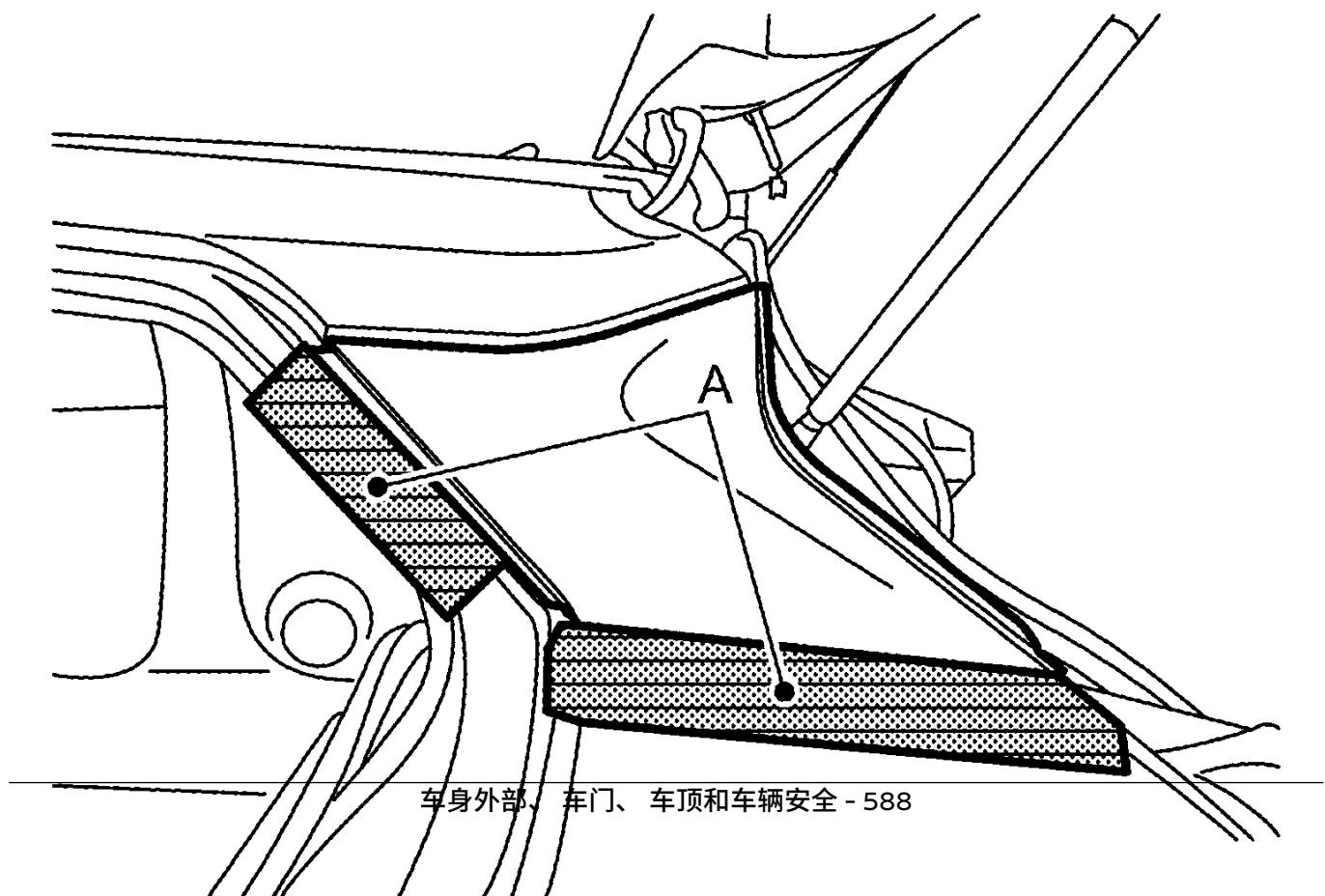
用拆卸工具(A)分开后翼子板盖固定卡子，然后拆下后翼子板盖。
